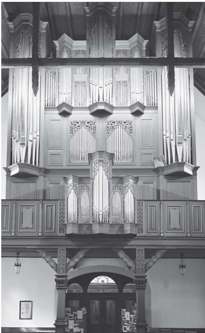
Erbauer: Alfred Führer Orgelbau, Wilhelmshaven, 1984 Disposition: Heiner Graßt (in Zusammenarbeit mit Fritz Schild) Mechanische Spiel- und Registertraktur Stimmung nach Werckmeister III Koppeln BW/HW und RP/HW als Schiebekoppeln Pedalkoppeln BW/P, HW/P und RP/P Tremulanten für BW und RP
